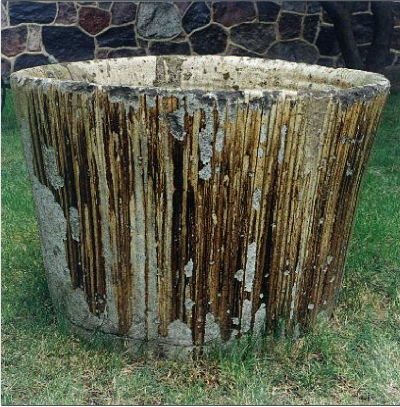
Abb. 3: Glasschmelzhafen der letzten produzierenden Glashütte Mecklenburgs, Alt Schwerin, Stilllegung 1901. Höhe = 77,5 cm, oberer Durchmesser = 86,0 cm, Foto: Moths, vor dem Agrarhistorischen Museum Alt Schwerin 2002
